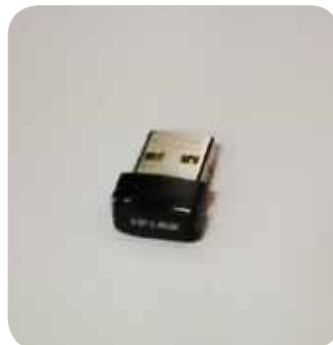
Mini Wireless USB Adapter. TRENDNET N150 TEW-648UB (optional)
