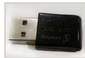
Mini Wireless USB Adapter. TRENDNET N150 TEW-648UB (optional)
